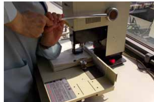
ペーパードリルで穴あけ
