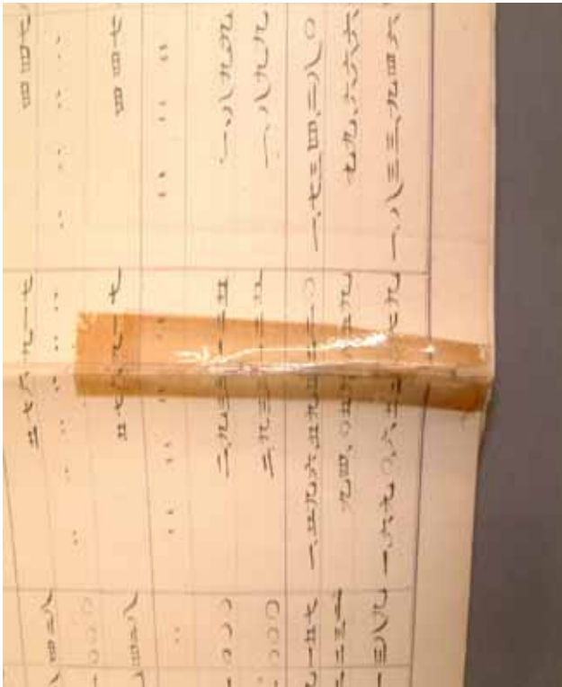
写真 1: 湿式コピーの銀塩化一両側は銀塩化が進み字が判読できない状態になっている。
