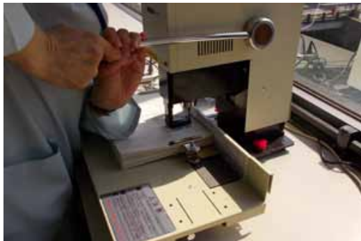
ペーパードリルで穴あけ
